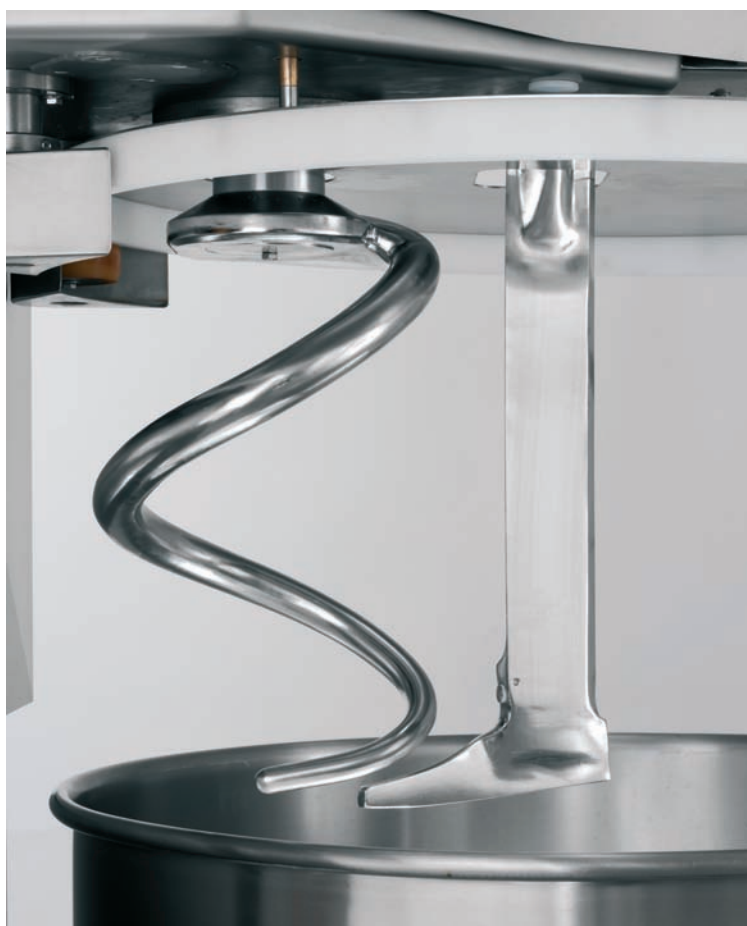
Der Luftschlag beim Kneten sorgt für Sauerstoffeintrag in den Teig und damit für eine trockene, gut weiter verarbeitbare Teigoberfläche. Foto: Kemper
